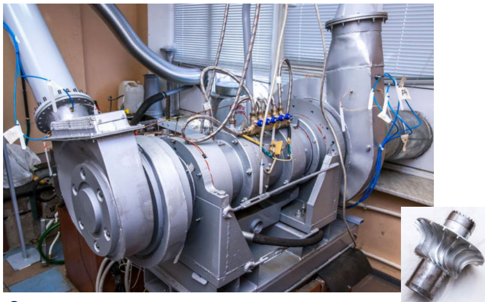
Стенд для исследования компрессоров и турбин мощностью до 500 кВт
