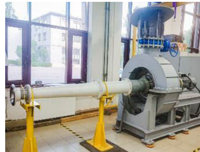
Экспериментальный стенд с высокочастотным электродвигателем и ротором модельной ступени на подшипниках качения
