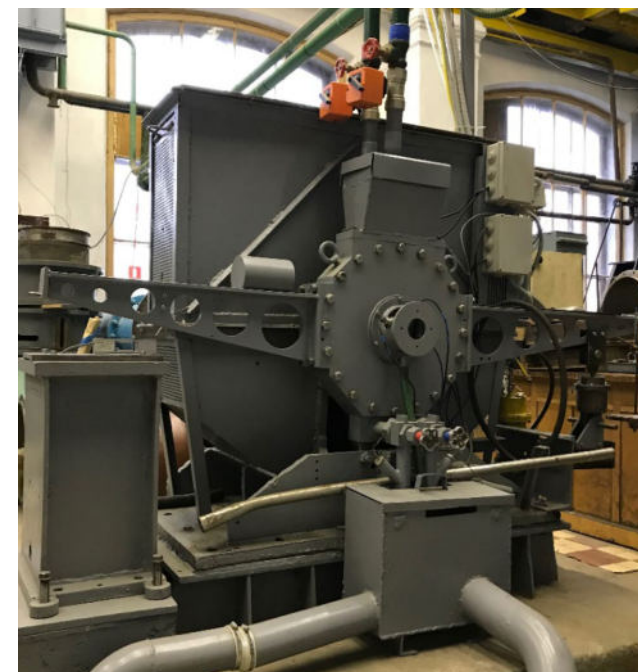
Стенд для исследования ступеней турбины привода парового насоса
