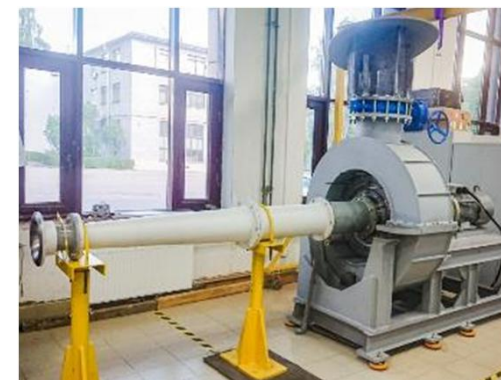
Экспериментальный стенд с высокочастотным электродвигателем и ротором модельной ступени на подшипниках качения
