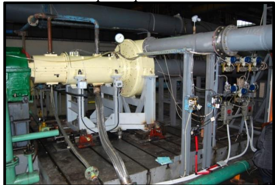
Аэродинамический стенд АДС-1250 для испытания модельных ступеней
