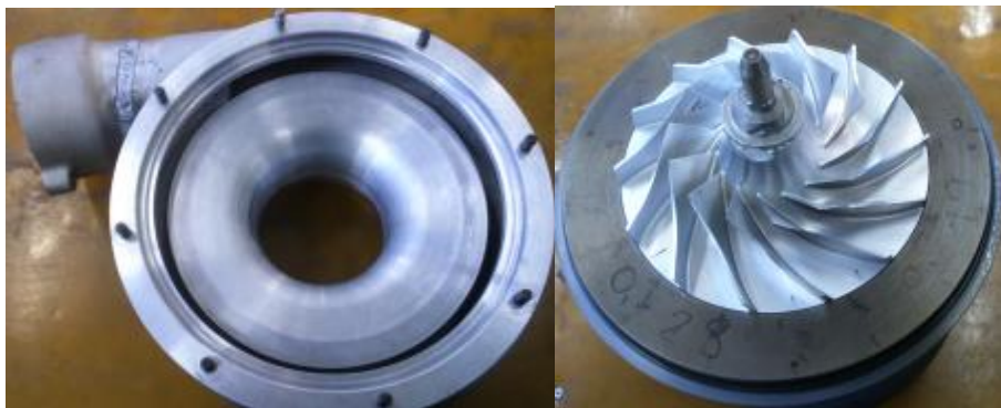
Элементы конструкции компрессора ТКР 140Э
