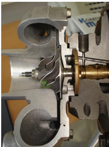
Разрез турбонагнетателя ДВС в составе «центробежный компрессор + радиальная турбина» и теплотоки в агрегате
