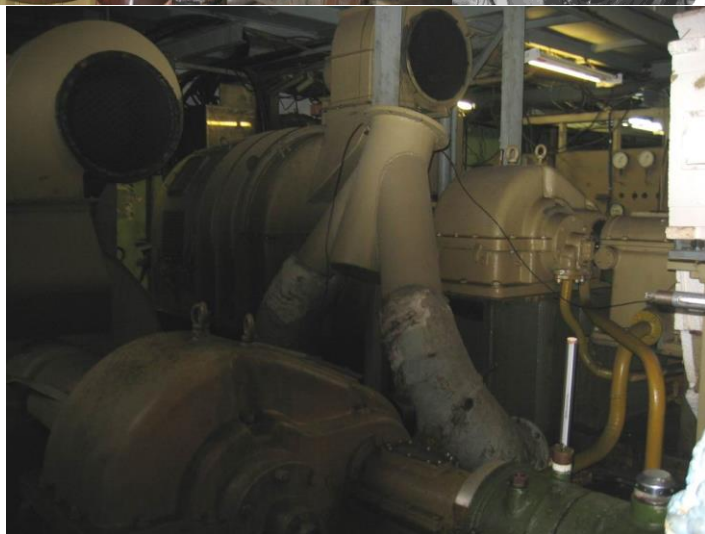
Некоторые из экспериментальных стендов кафедры для испытания центробежных компрессоров. Мощность до 800 кВт, скорость вращения до 18000 об/мин, окружная скорость до 450 м/с, давление в контуре до 100 бар.
