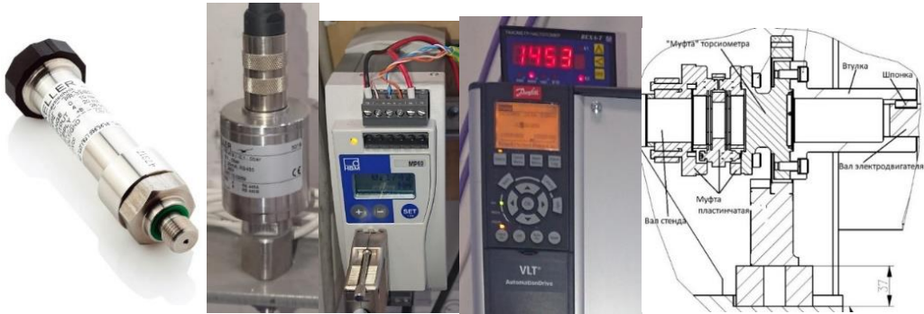
Элементы электронной измерительной системы стэнда ЭЦК-55
