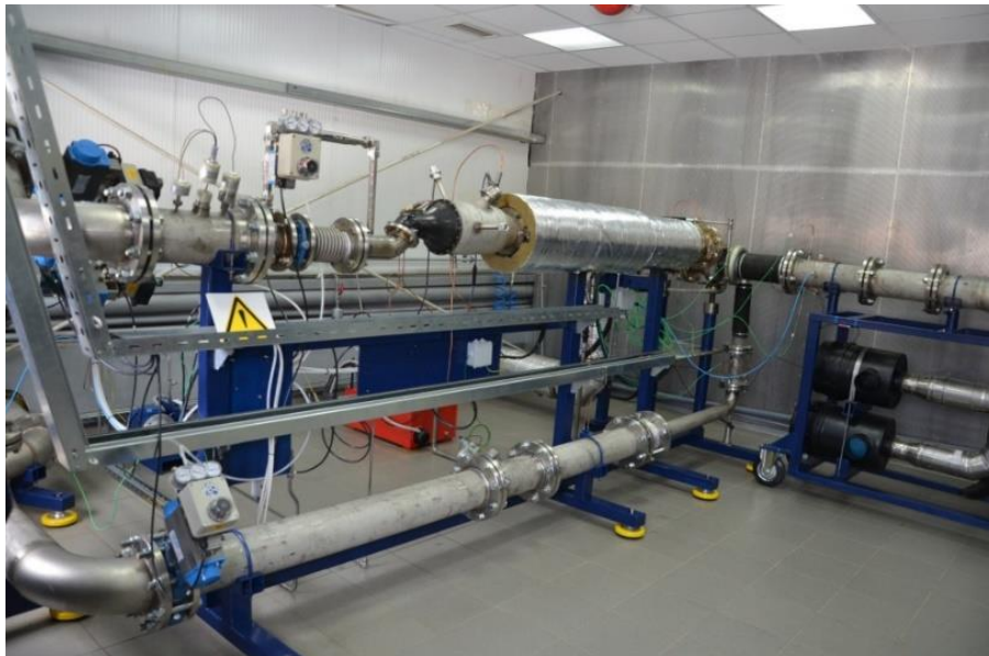
Стенд испытаний турбокомпрессоров АО «НПО «Турботехника»
