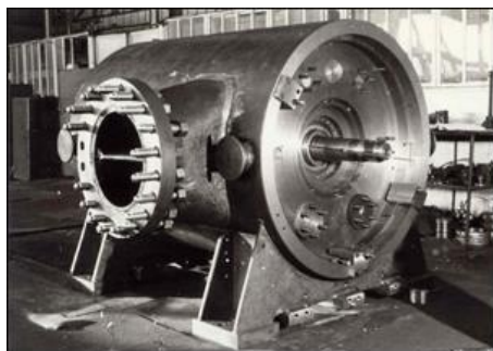
Корпус нагнетателя газоперекачивающего агрегата в процессе сборки
