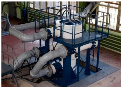
Турбодетандерный агрегат АДКГ-20 с компрессором ТК-6. Серийный агрегат с наибольшим объемным расходом и размерами. Ротор с вертикальной осью создает минимальную нагрузку на магнитные подшипники
