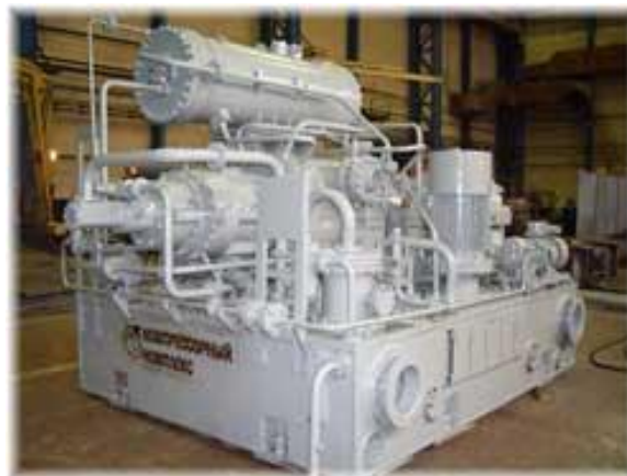
Компрессор ГПА с регулируемым электроприводом
