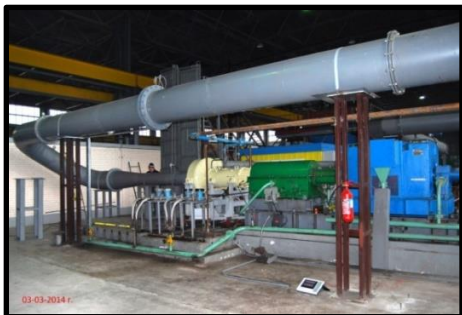
Аэродинамический стенд АДС-1250 для испытания модельных ступеней
